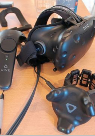
Das VITA-System, HTC Vive System (Brille), Sensorenarmband und Controller.
